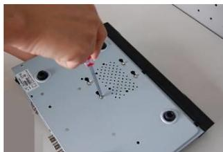
6. Avvitare le viti per fissare il disco fisso al contenitore
